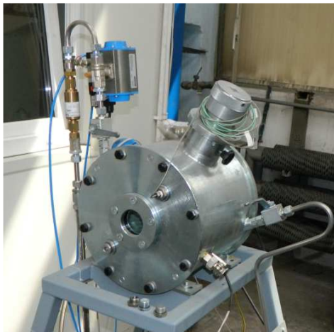
Rys.5. Komora do prowadzenia badań wybuchowości mieszanin gazowych [11]
