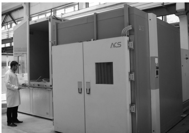
Rys.1. Komora do badań klimatycznych (pierwszy plan) oraz komora pyłowa do badania stopnia ochrony obudowy (Kod IP) [11]
