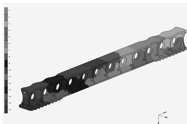
Rys.3. Podział modelu obliczeniowego po zastosowaniu funkcji DDM w programie obliczeniowym MSC.Marc/Mentat [3]
